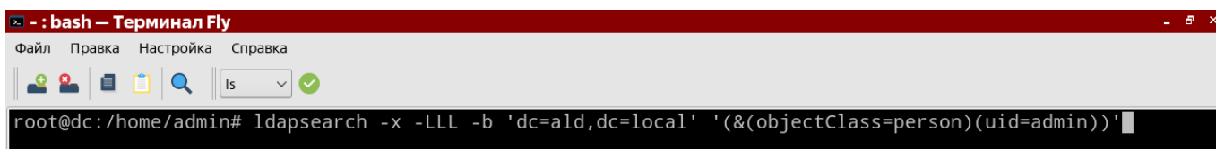
Рисунок 5.55 – Команда получения «UID» администратора сервера ALD Pro
